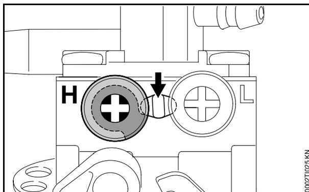
Il est interdit de réutiliser un capuchon qui a été démonté une fois, car il a été endommagé à l'extraction.
