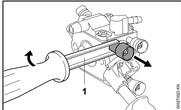
Pour le remplacement d'une vis de réglage de richesse à haut régime (**H**) défectueuse ou pour le nettoyage du carburateur, à l'atelier de service après-vente, le capuchon de limitation de course de réglage de la vis de réglage de richesse à haut régime (**H**) doit être enlevé.
