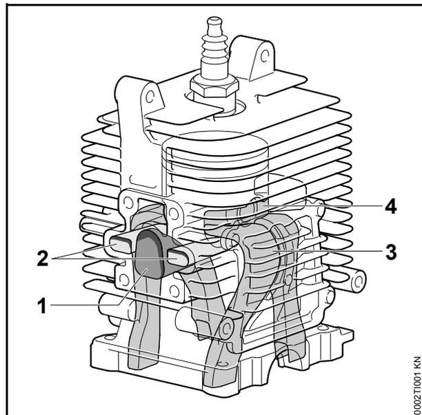
Le canal de gaz frais (1) et le canal d'air pur (2) sont séparés. Une auge de distribution (4) est moulée dans la jupe du piston. C'est avec cette auge de distribution que le piston ouvre et ferme la communication entre les canaux d'air pur et les canaux de transfert (3). Aucune autre pièce n'est nécessaire pour la distribution de l'air pur.
