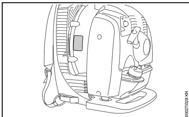
Le numéro de machine est appliqué sur le côté du carter de turbine – comme montré sur l'illustration.
