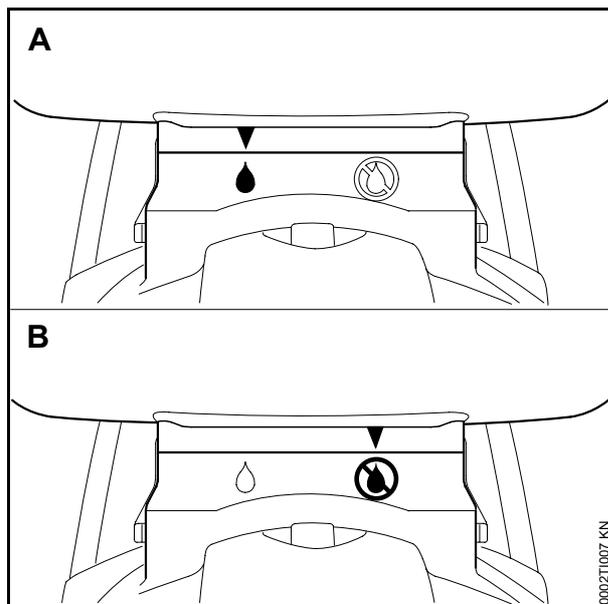
Le mode de fonctionnement réglé est indiqué par les symboles appliqués sur le boîtier du dispositif de dosage.
