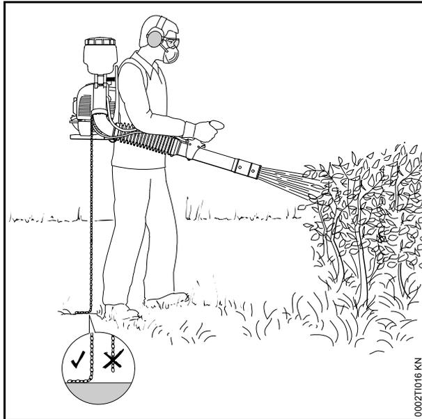
Pour réduire le risque de jaillissement d'étincelles et de déflagration ou d'incendie, il faut que le système de dérivation des charges électrostatiques soit intégralement monté sur la machine. Le système est composé d'un fil conducteur posé dans l'installation de soufflage et relié à une chaîne métallique. Pour que les charges électrostatiques puissent être dérivées dans le sol, il faut que la chaîne métallique soit en contact avec un sol conducteur.
