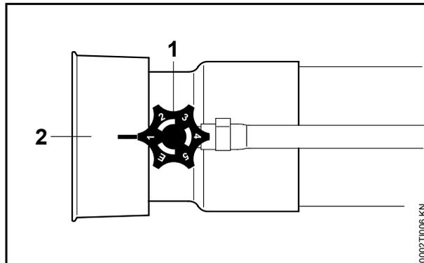
Le robinet de dosage (1) permet de régler le débit nécessaire.
